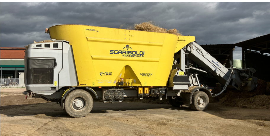
La capacità di 32 metri cubi unita a due soli assi combina elevate prestazioni con un'alta manovrabilità
