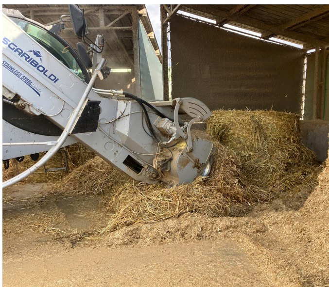
I mulino sulla fresa è un componente strategico per il carro miscelatore: consente di scegliere la lunghezza a cui tagliare il prodotto e di lavorare velocemente
