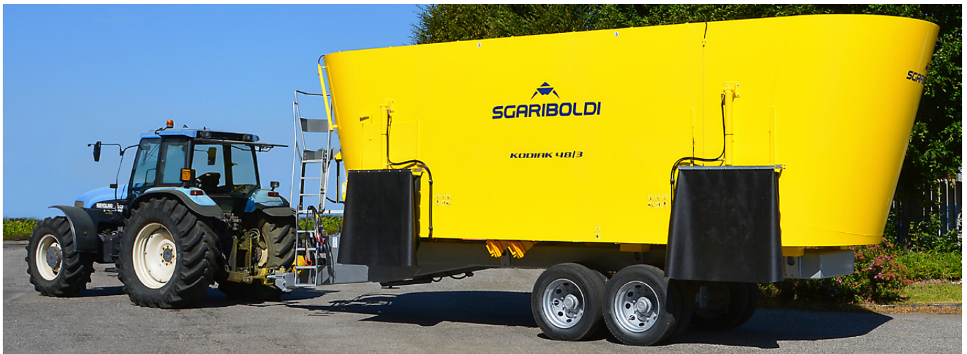
Il nuovo carro da 48 metri cubi citato nel riquadro pubblicato sopra. È il carro trainato Kodiak, con nuovo cambio powershift per le coclee
