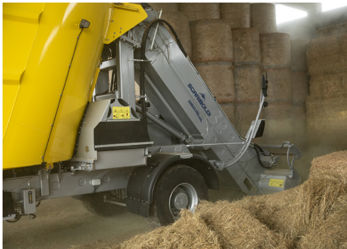
Grazie al mulino è possibile caricare fieni e rotoballe fasciate con un taglio uniforme
