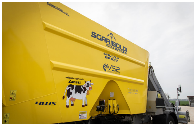
La serie Titanium dei carri Sgariboldi è dedicata a macchine di grandi dimensioni, realizzate con acciai speciali per ridurre il peso e aumentare la capacità di carico
