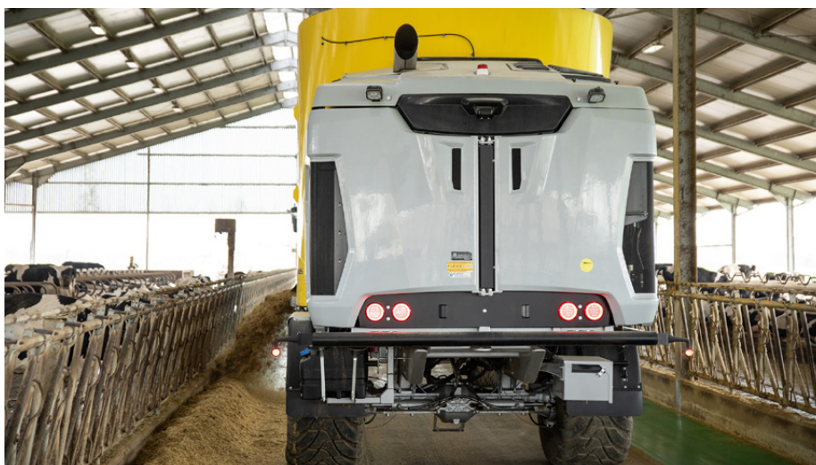
La doppia coclea e il volume di carico di 40 metri cubi hanno dimezzato i tempi di preparazione e distribuzione della razione
