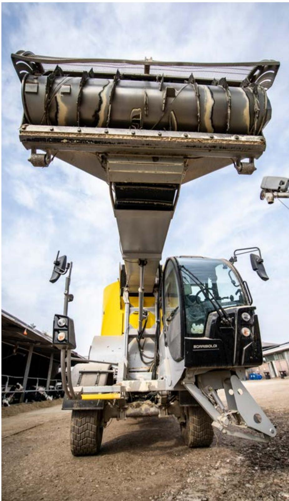
**Una visione frontale del carro miscelatore semovente Grizzly 8130 S della Sgariboldi, in uso all'azienda agricola Gomiero, di Limena (Pd). In evidenza la grande fresa, che può alzarsi sino a 5,8 metri. E in basso a destra nella foto si nota l'autolift, ossia il gruppo di scalini mobili che garantisce un comodo ingresso in cabina**
