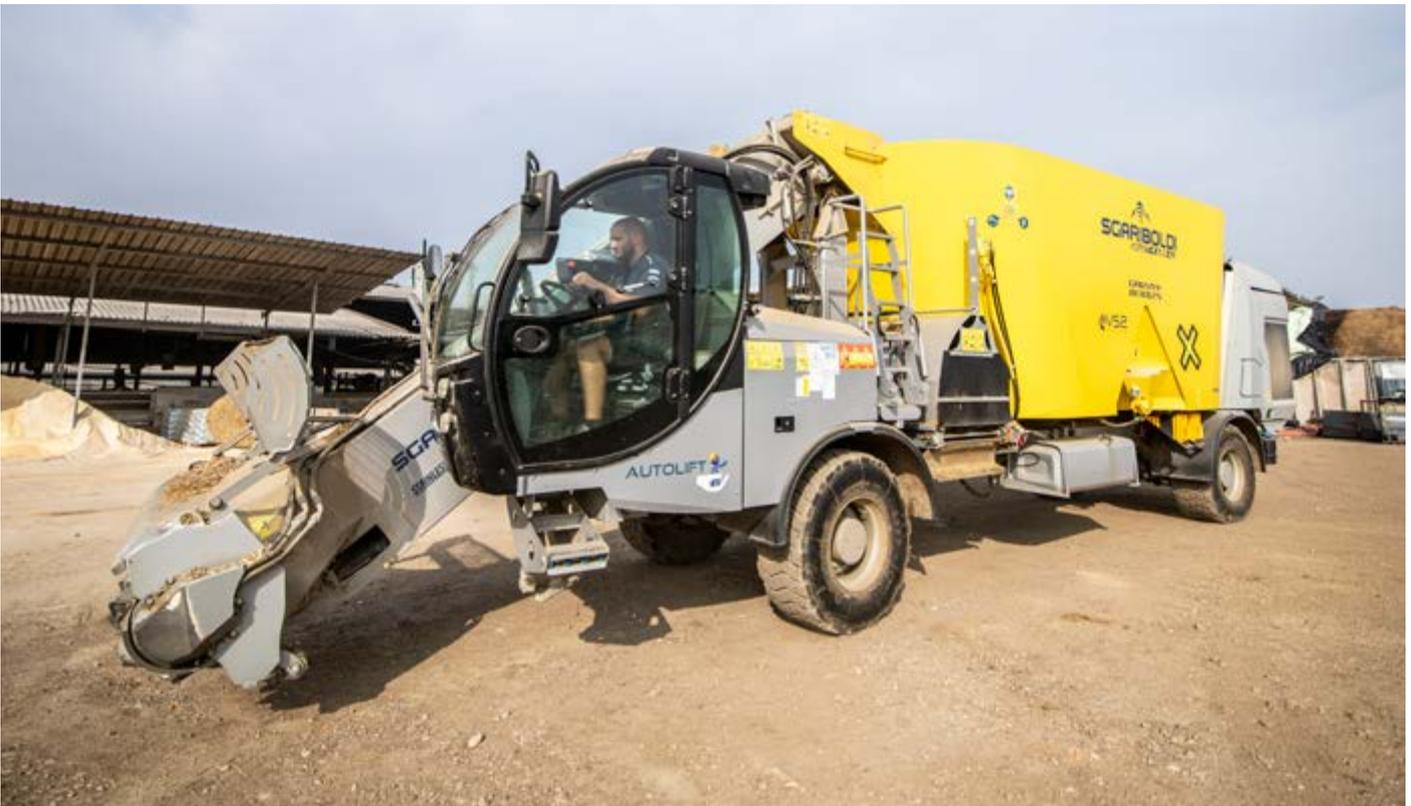
**Davide Gomiero alla guida del carro miscelatore Grizzly 8130 S della Sgariboldi, una macchina semovente, dalla capacità di 30 m<sup>3</sup>, con due coclee verticali**
