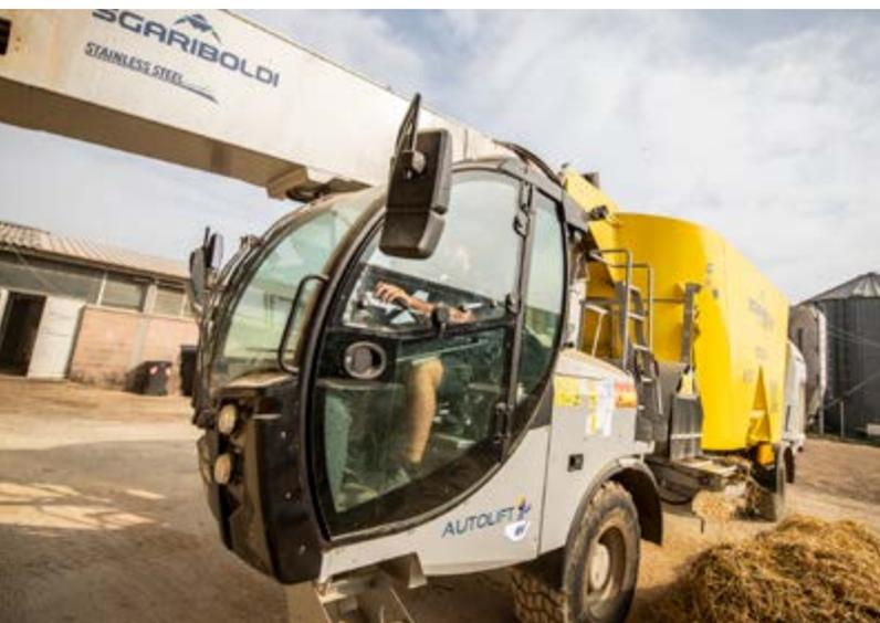
La cabina montata sul mixer di Gomiero è una I-Cab II, "cabina intelligente" firmata Sgariboldi e giunta ormai alla seconda generazione. Si distingue non solo per le prestazioni ma anche per gli elevati livelli di comfort
