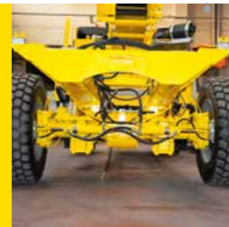
Hydraulische Federung und automotiv Fahrsteuerung
