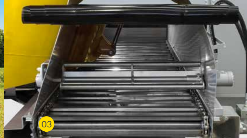
03 Rotierender Magnet am Austrag
