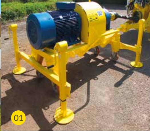
01 Elektromotorwagen für stationären Betrieb
