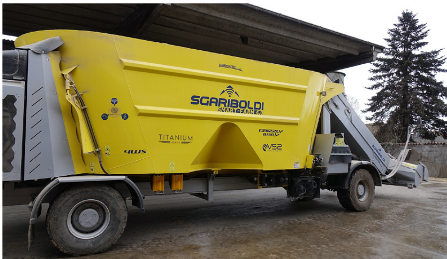
La fiancata del carro adottato dall'azienda Lupo Stanghellini. Il carro, semovente, poggia su due soli assi, situazione che garantisce una elevata manovrabilità nonostante le grandi capacità di carico
