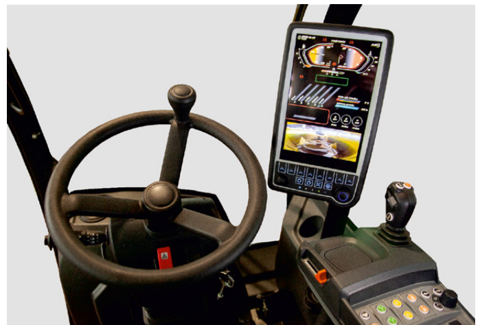
Nella cabina è presente un display che visualizza i parametri generali di macchina, motore e idraulica, con impostazioni personalizzabili. Mostra anche ciò che riprendono le telecamere (opzionali) per il controllo del lavoro della macchina
