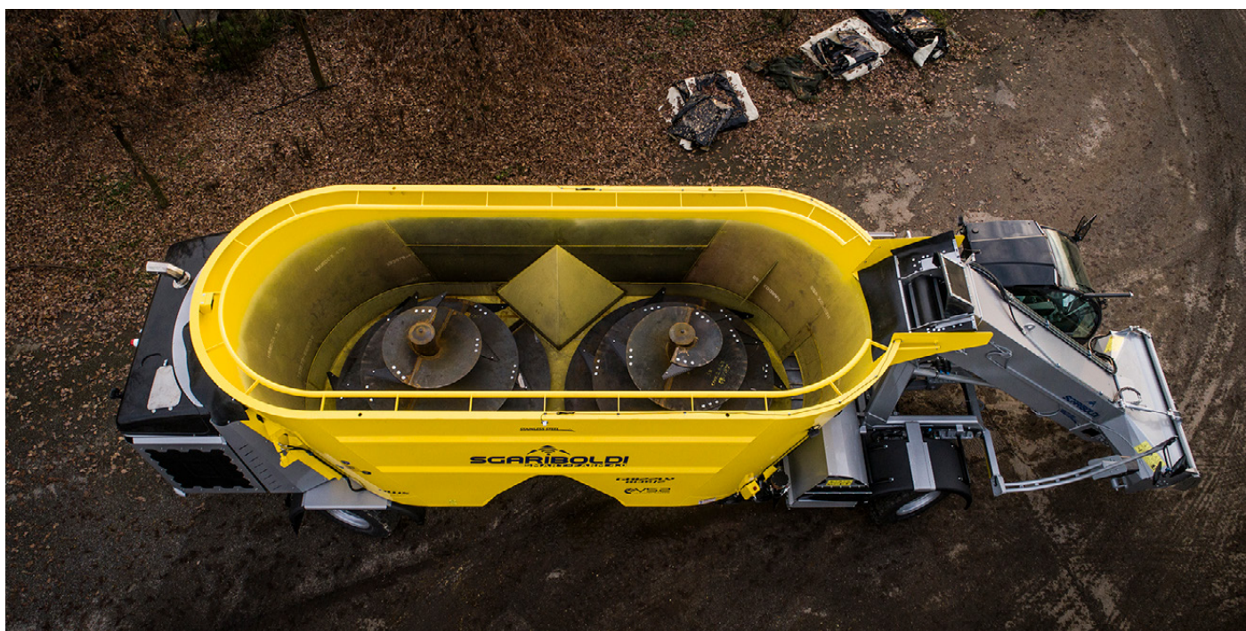
La grande capacità della vasca, ben 36 mc. Presenti due coclee verticali
