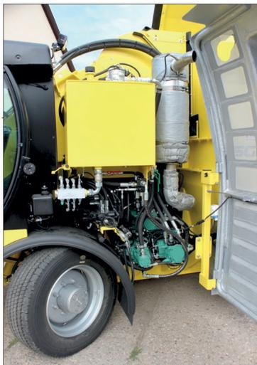
Veškeré pohony vozu jsou hydrostatické. Hlavní pohony mají: pojezdové ústrojí, vybírací fréza, míchací systém a rezačka. Dále je přítomen hydrogenerátor pro pracovní hydrauliku a čerpadlo po pohon hydromotoru ventilátoru chlazení
