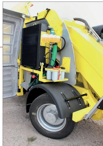
Motor byl z pravé strany posunut doprostřed za kabinu. Vpravo zůstal jen blok chladičů
