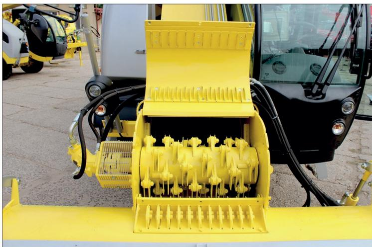
Hydrostaticky poháněná rezačka umožňuje zkrácení stébelnatých materiálů
