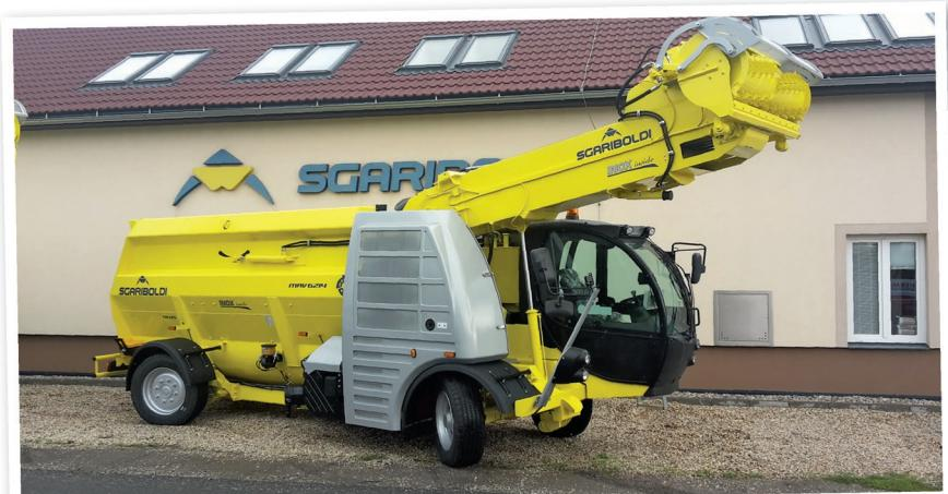
Krmný míchací vůz Sgariboldi Gulliver 6000 ve čtrnáctikubíkovém provedení
