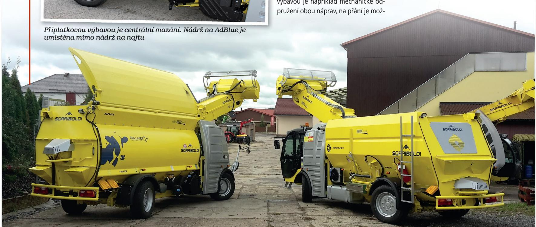
Vlevo krmný vůz Gulliver 600 s lopatkovým systémem míchání, vpravo krmný vůz MAV 6200 s míchací vanou opatřenou jedním horizontálním šnekem
